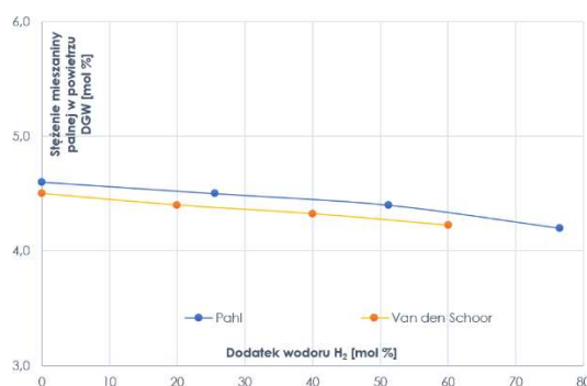
Rys. 2. Wartości DGW dla mieszaniny metanu i wodoru w powietrzu [5].
